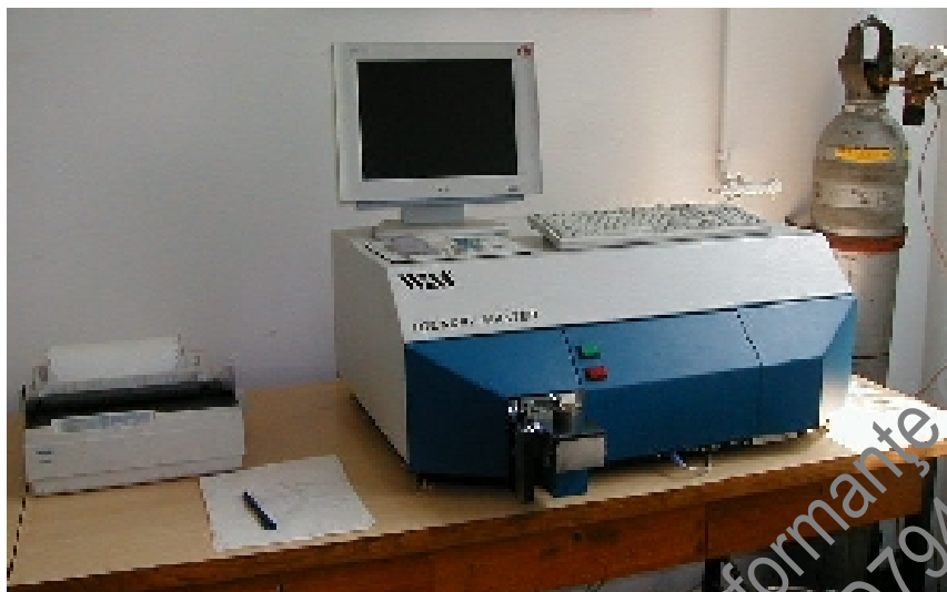
Figura 4.1. Echipament Foundry Master utilizat în determinarea compoziției chimice a aliajelor feroase și neferoase
